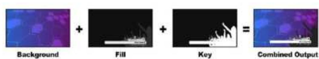
Combinación del fondo y el primer plano en una composición lineal
