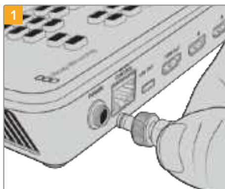
Connectez l'alimentation à l'entrée d'alimentation de l'ATEM Mini à l'aide du câble fourni.
