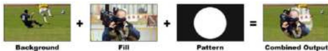
将背景和填充及图案键进行合成
