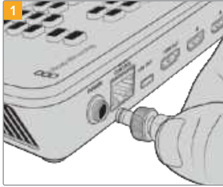
1 Kutuda gelen kabloyu kullanarak ATEM Mini'nin güç girişine elektrik bağlayın.
