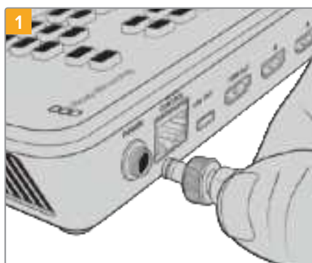
通过所提供线缆将ATEM Mini电源输入与电源相连
