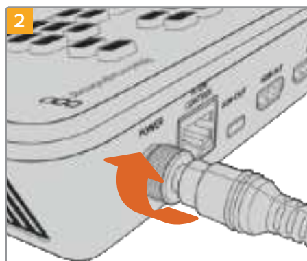
Avvita l'anello di sicurezza per collegare il cavo saldamente
