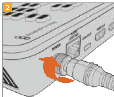
Sécurisez la connexion à l'ATEM Mini en serrant le connecteur à l'appareil.
