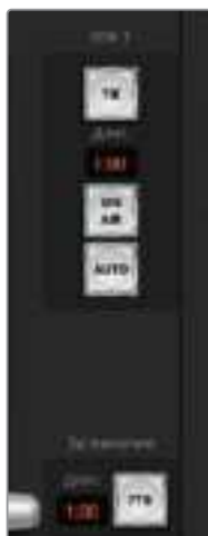
Модуль вторичного кеинга и полное затемнение
